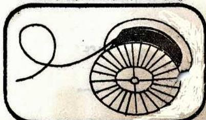
CABLE ACIER ACO : le plus robuste. Monoton en acier galvanisé de 12 brins de 0,30 mm. Résistance : 200 k/mm<sup>2</sup>. Bobines de 250 m ou 350 m (2,5 k)
